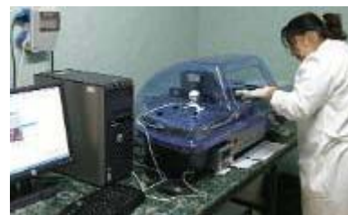
Prepararea unui slide pentru detectia proteinei C cu ajutorul Microplotter-ului
